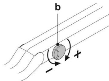
Устройство остановки пружинных рычажков возврата инструментов (только вариант исполнения со шнурами с верхней подачей).
