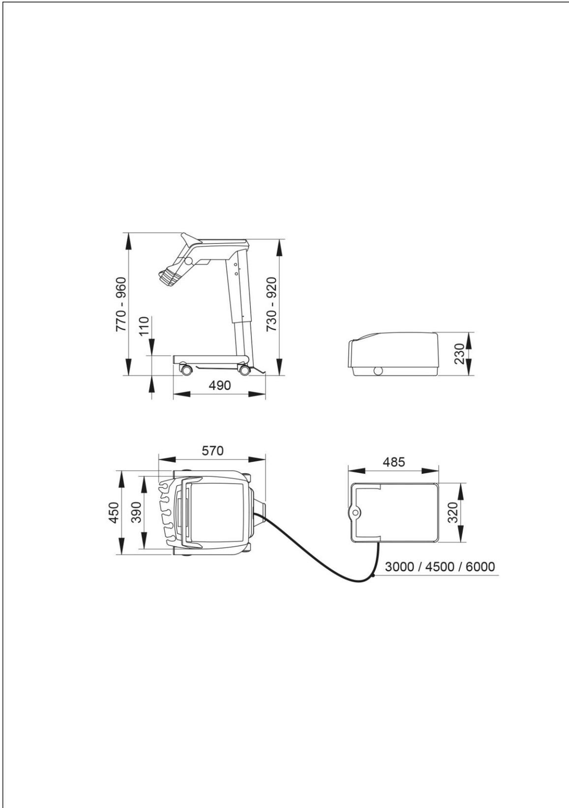
11.7. РАЗМЕРЫ МОДЕЛИ A5 IDRICO SINGOLO
